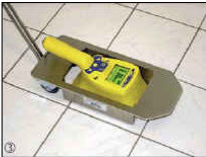
CoMo placed in floor control device
